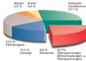
Bild 1: Elektronik-Schäden im Jahr 2001, Analyse von 7370 Schadensfällen (Lit.: Württembergische Versicherung AG)
